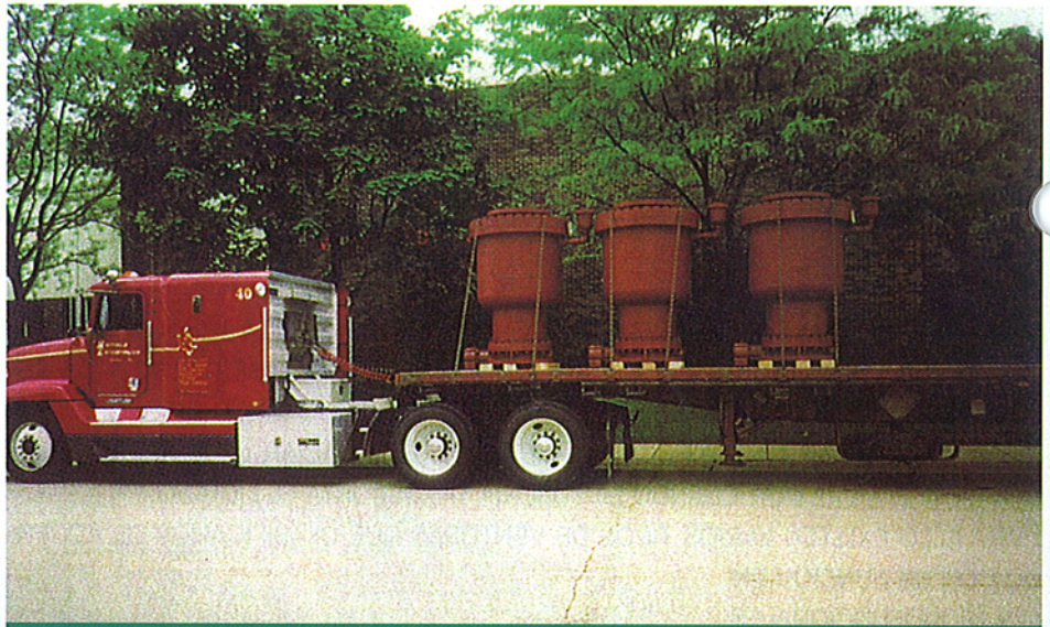
Foto 2. Ventosas para una tubería de gran diámetro. Eliminan grandes cantidades de aire lo que impide roturas o "tapones de aire" en la conducción.
